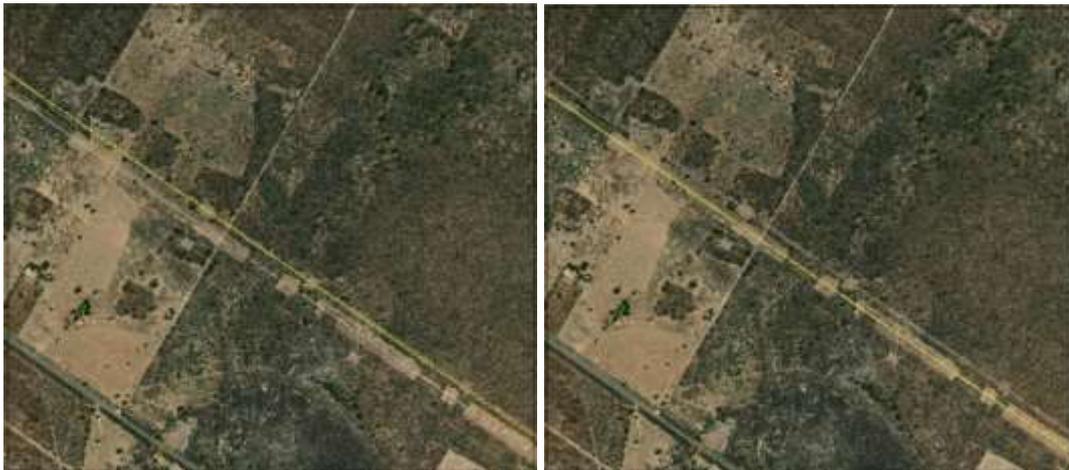
**Figura 9** - Exemplo de ajuste no shapefile de LT do IBGE: imagem da esquerda – linha tracejada em amarelo representa o eixo da linha; imagem da direita representa o eixo da linha casando com a imagem de referência.
